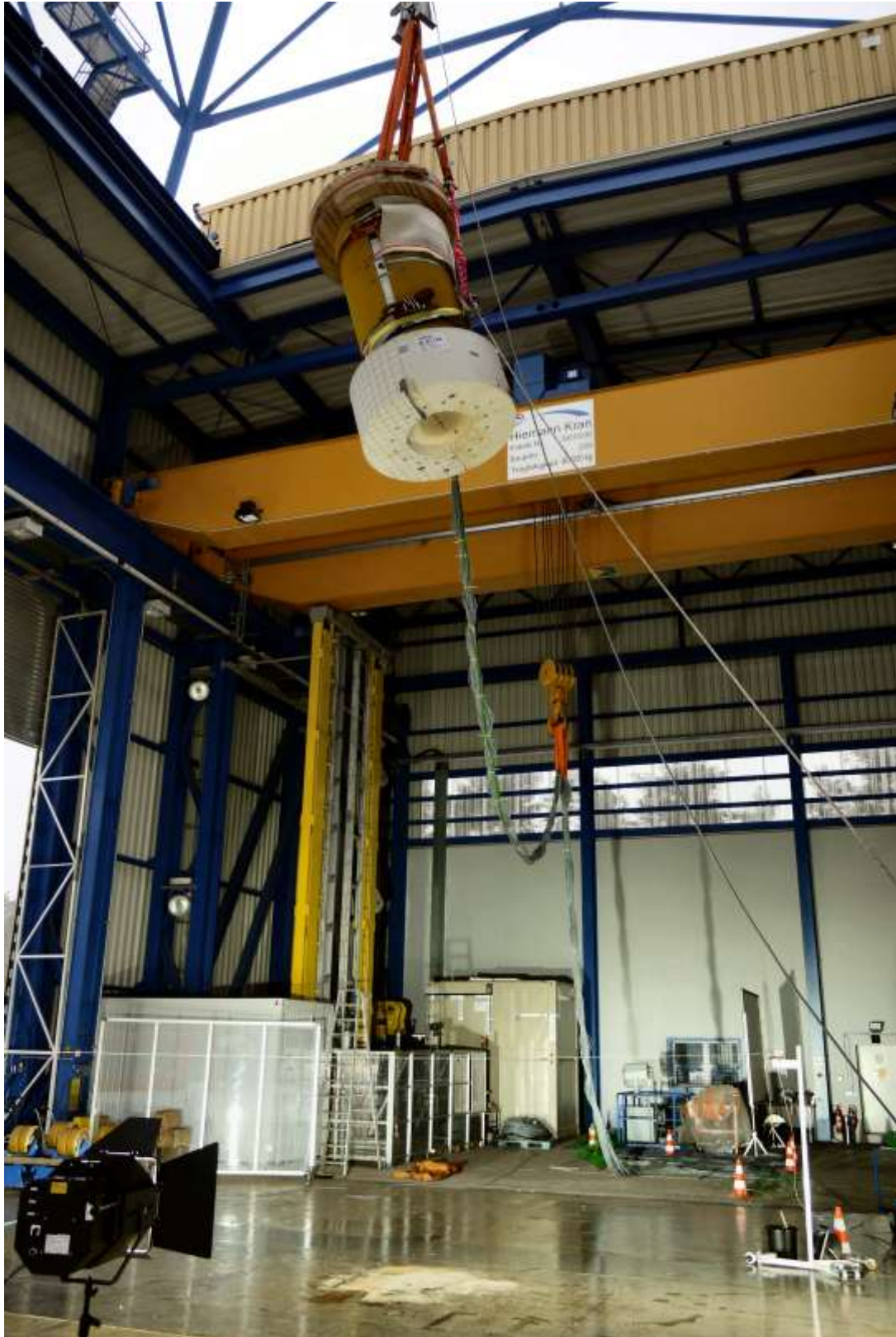
Abbildung G-1: Fallversuch eines Transport- und Lagerbehälters für verglaste Abfälle im Versuchsstand der Bundesanstalt für Materialforschung und -prüfung (BAM) im Rahmen eines verkehrsrechtlichen Zulassungsverfahrens (Bildrechte: BAM)
