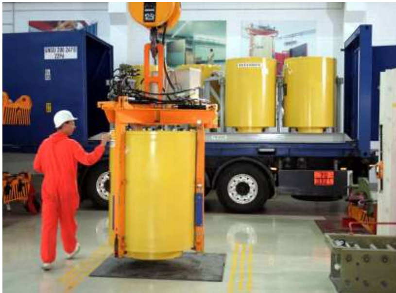
Abbildung F-3: Wischtest zur Produktkontrolle an einem MOSAIK-Behälter (Bildrechte: GNS)
