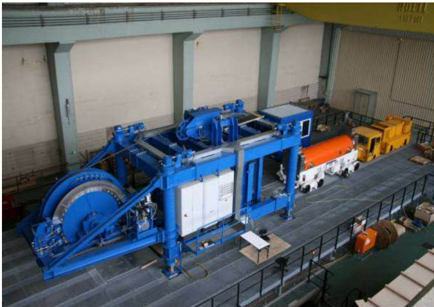
Abbildung D-7 : Versuchsstand zur Weiterentwicklung der Bohrlochlagertechnik
