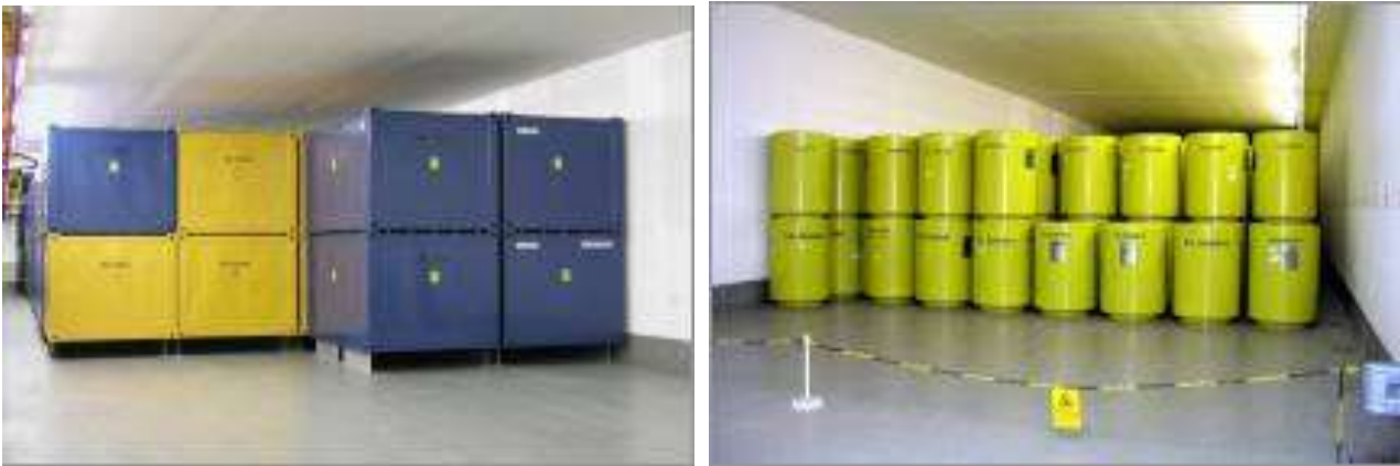
Abbildung D-11: Beispiele für standardisierte Abfallbehälter (links Konrad-Container, rechts Gussbehälter) (Bildrechte: GNS)
