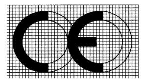
Bei Verkleinerung oder Vergrößerung der CE-Kennzeichnung müssen die sich aus dem in dieser Nummer abgebildeten Raster ergebenden Proportionen eingehalten werden.
