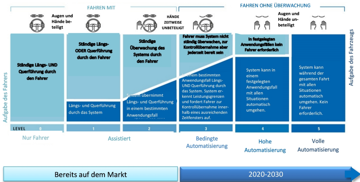
Abbildung: Verschiedene Stufen der Automatisierung (Quelle: Verband der Automobilingenieure (Society of Automotive Engineers, SAE) 11 )
