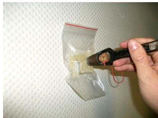
Abb. 6: Stanzeisen auf das doppelseitige Klebeband setzen
