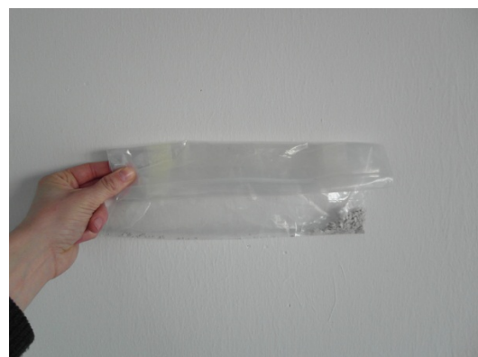
Abb. 6: Öffnung auf der Vorderseite der Schleuse durch Herunterklappen des oberen Teiles der Folienschleuse verschließen
