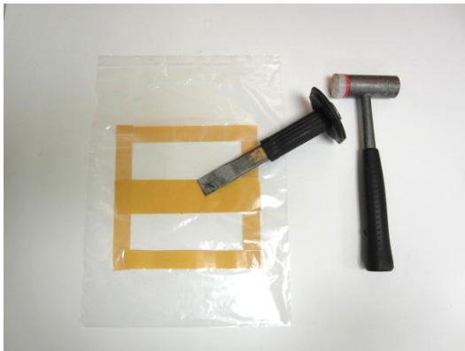
Abb. 1: Vorderseite der Stanzschleuse, notwendiges Werkzeug
