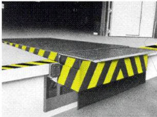
Bild 6 Sicherung von Quetsch- und Scherstellen. Abdeckbleche sichern die Quetsch- und Scherstellen an den Seiten der Ladebrücke. An der Vorderseite (Hofraumseite) sichert eine Gummischürze gegen den Zugriff zum Gefahrenbereich unter der Ladebrücke
