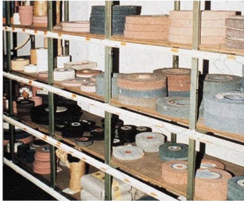
Bild 5-2: Lagerung von Schleifscheiben stehend in Gestellen
