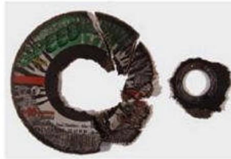
Bild 7-1: Durch unzulässig hohe Seitenlast gebrochene 1 mm dünne Trennschleifscheibe (unsachgemäße Verwendung)
