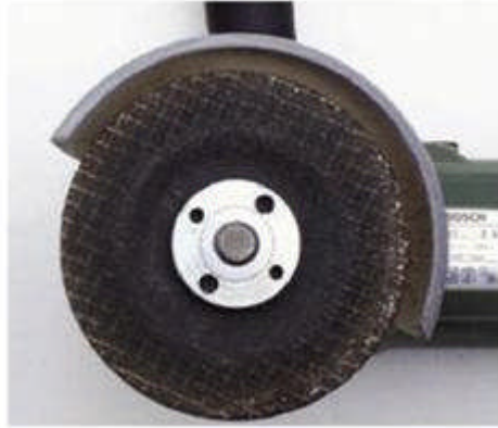
Bild 8-6: Winkelschleifer mit Schutzhaube mit außen liegendem Segment
