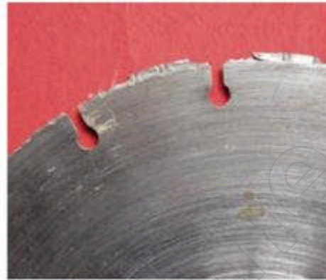
Bild 7-4: Diamanttrennschleifscheibe mit vollständig verschlissenen Schleifsegmenten (unsachgemäße Verwendung)
