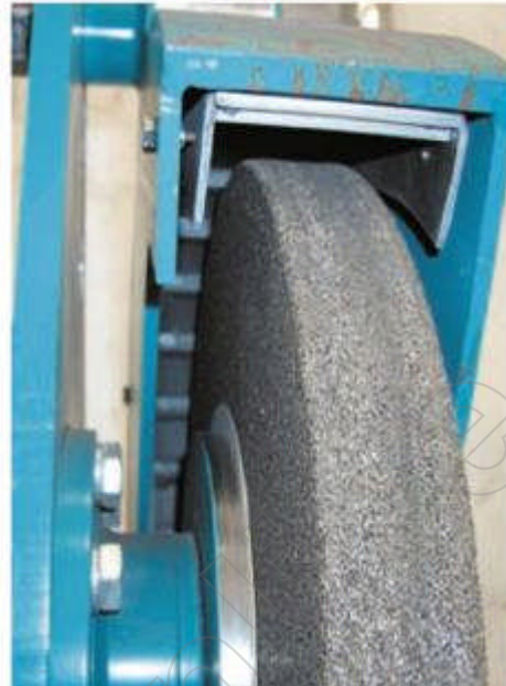
Bild 8-3: Schutzhaube mit Rot-Visier an einer Ständerschleifmaschine für das Umfangschleifen mit v_s > 50 m/s
