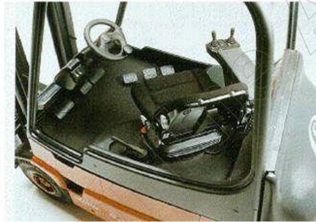
Bild 6-18: Drehbarer Fahrersitz - System "Linde"
