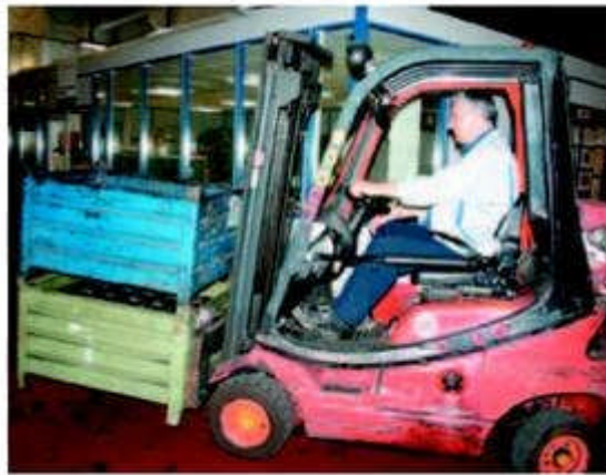
Bild 6-14: Nach hinten geneigter Hubmast
