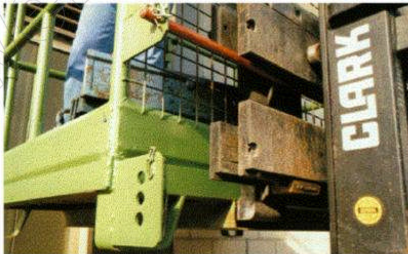
Bild 8-3: Formschlüssige Sicherung der Arbeitsbühne gegen Abkippen und Abrutschen
