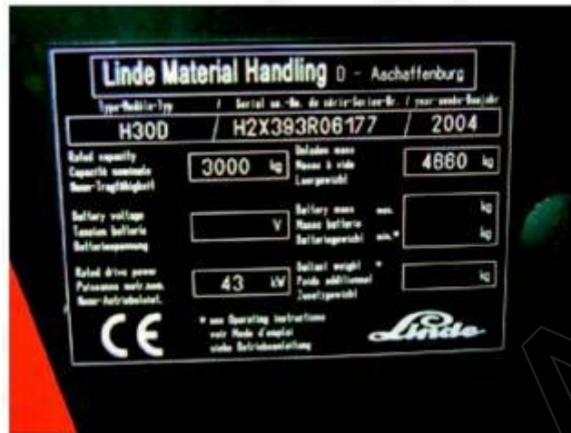
Bild 2-1: Fabrikschild mit CE-Zeichen für ein Flurförderzeug
