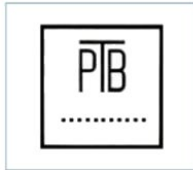
Bild 7-6: Prüfzeichen für Bolzenschubwerkzeug. Es ist bis zwei Jahre nach erfolgter Prüfung gültig. Die Zahl des Quartals, in dem das Gerät geprüft wurde, zeigt in Richtung der Laufmündung
