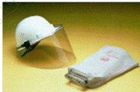
Bild 5-13: NH-Sicherungsaufsteckgriffe mit Stulpe (DIN VDE 0680-4), Industrieschutzhelm nach DIN 4840 mit Gesichtsschutzschirm mit UV-Filterwirkung zum Schutz gegen Störlichtbögen (DIN EN 397)
