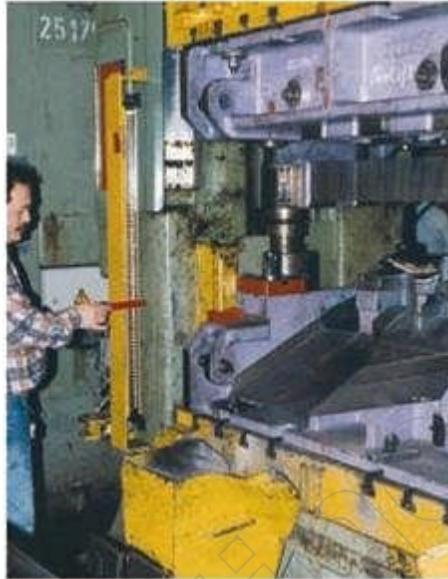
Bei diesen Prüfungen ist besonders darauf zu achten, dass der verwendete Prüfstab zum jeweiligen Auflösungsvermögen der BWS passt (unterschiedliche Durchmesser). Darüber hinaus sind die Prüfvorschriften aus der Bedienungsanleitung des jeweiligen Pressen- bzw. Herstellers der BWS zu beachten.
