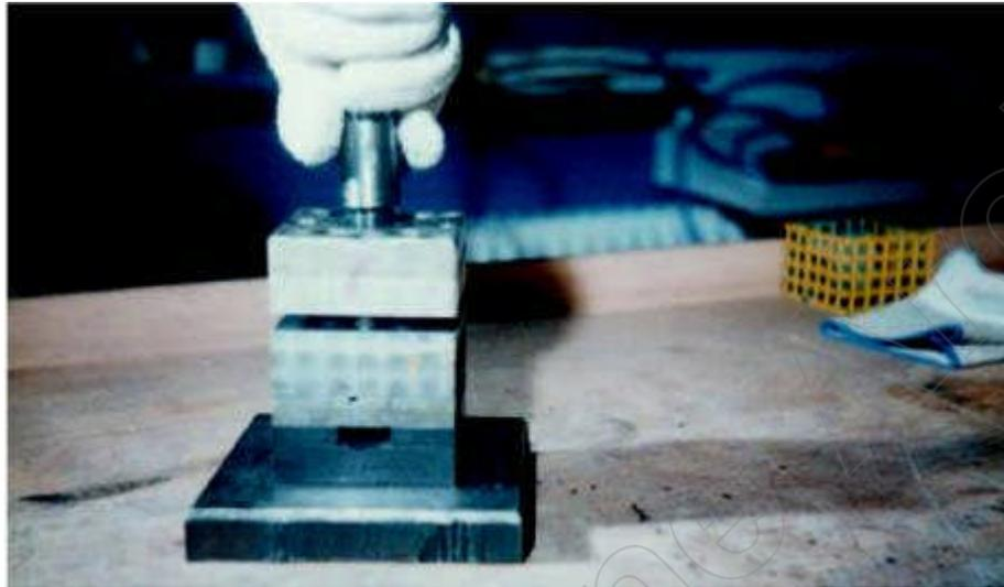
Durch die Bewegung des Stößels und des am Stößel befestigten Oberwerkzeuges können Quetsch- und Scherstellen entstehen.
