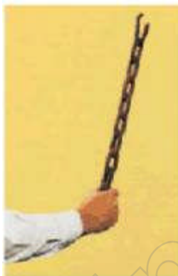
Bild 23-12: Die Keife ist ablegereif, wenn ein oder mehrere Glieder außen um je 3 % gelängt sind. Dies entspricht einer inneren Längung von 5 %
