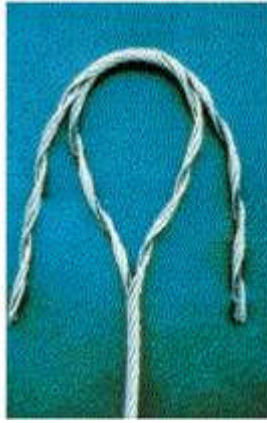
Bild 9-7: Die beiden Enden sind gegeneinander verseift
