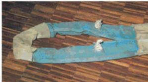
Bild 23-19: Die Einlage einer Rundschnur besteht meist aus einer einzelnen Kardeele, die mindestens 11-mal umläuft. Wird diese nur einmal durchgeschnitten, ist der innere Verbund der Rundschnur durch Reibung nicht mehr gegeben!
