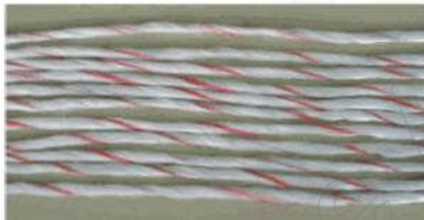
Bild 23-19: Die Einlage einer Rundschnur besteht meist aus einer einzelnen Kardeele, die mindestens 11-mal umläuft. Wird diese nur einmal durchgeschnitten, ist der innere Verbund der Rundschnur durch Reibung nicht mehr gegeben!
