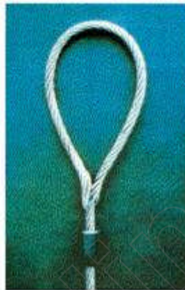
Bild 9-8: Über die gegenläufig verseiften Enden ist eine angeschrägte Stahlpresshülse geschoben und verpresst
