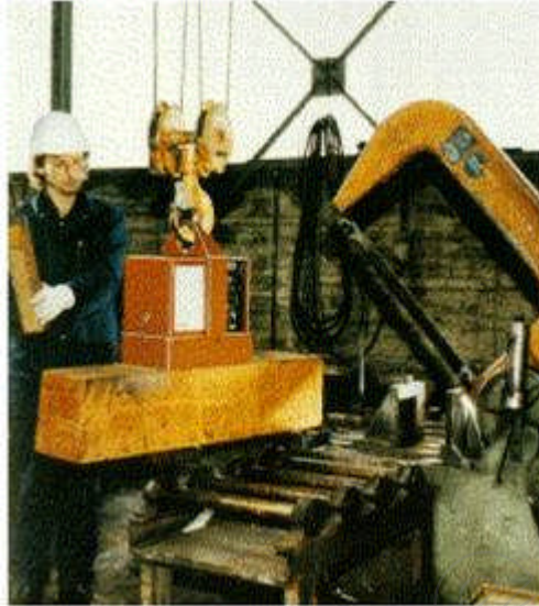
Bild 17-2: Batterie-Lasthebemagnet bei der Maschinenbestückung
