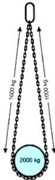
Bild 14-14: Wird eine Kranzette im Schnürgang um die Last gelegt, muss die Tragfähigkeit wegen der Biegebeanspruchung im Schnürpunkt auf 80 % der Tragfähigkeit des Doppelstranges verringert werden
