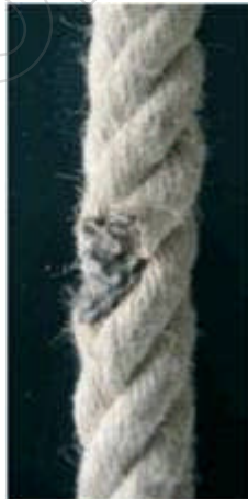
Bild 23-9: Wärmeeinfluss hat eine Litze zerstört
