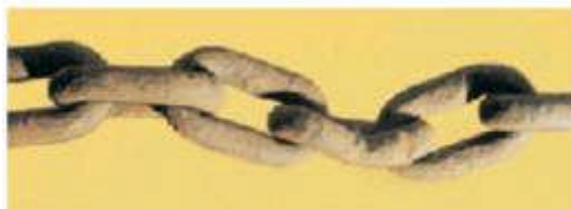
Bild 23-11: Durch Überlastung steif gezogene Kette
