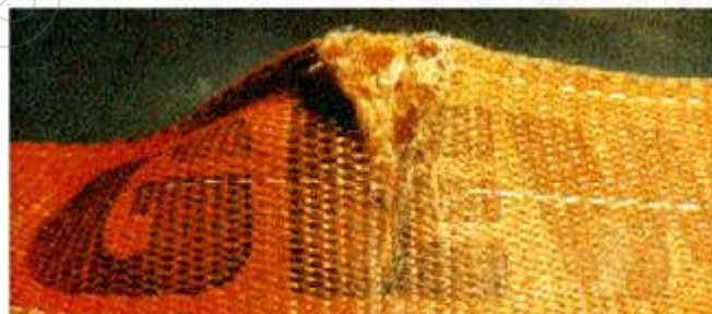
Bild 23-15: Durch Schnitte beschädigte Ummantelung und Einlage einer Rundschlinge
