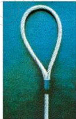
Bild 9-8: Über die gegenläufig verseiften Enden ist eine angeschrägte Stahlpresshülse geschoben und verpresst
