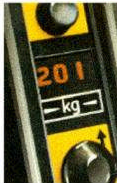
Bild 5-3: Steuerbirne mit digitaler Lastanzeige
