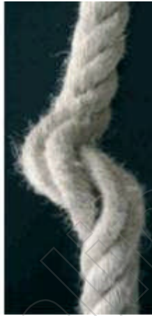
Bild 23-9: Wärmeeinfluss hat eine Litze zerstört
