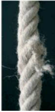
Bild 23-8: Durch Klanke zerstörter Litzenverbund
