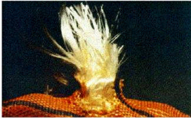
Bild 23-16: Durch Wärmeeinfluss zerstörte Ummantelung
