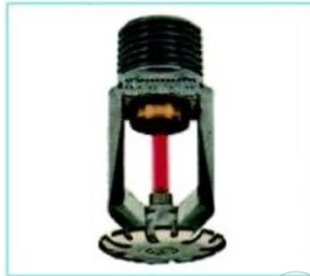
Es öffnen sich nur die im Brandbereich befindlichen Düsen. Dadurch wird ein möglicher Wasserschaden begrenzt.
