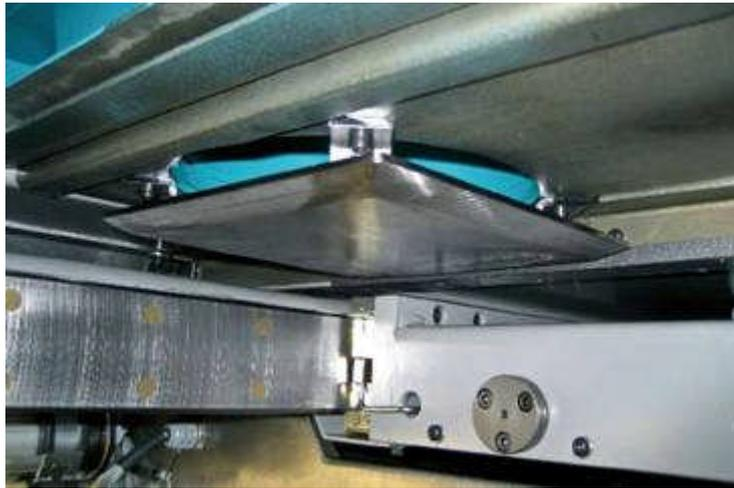
**Bild 35: Zugeseztes Spänegitter**
