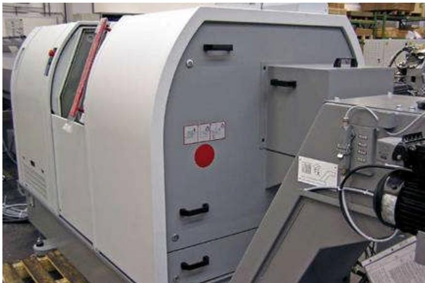
Die Löschöffnung muss so platziert sein, dass der gesamte Arbeitsraum geflutet werden kann. Durch die Löschöffnung dürfen keine weiteren Gefahren (z.B. Herausschleudern von Werkstücken, Quetschstellen bei offener Löschöffnung) entstehen.
