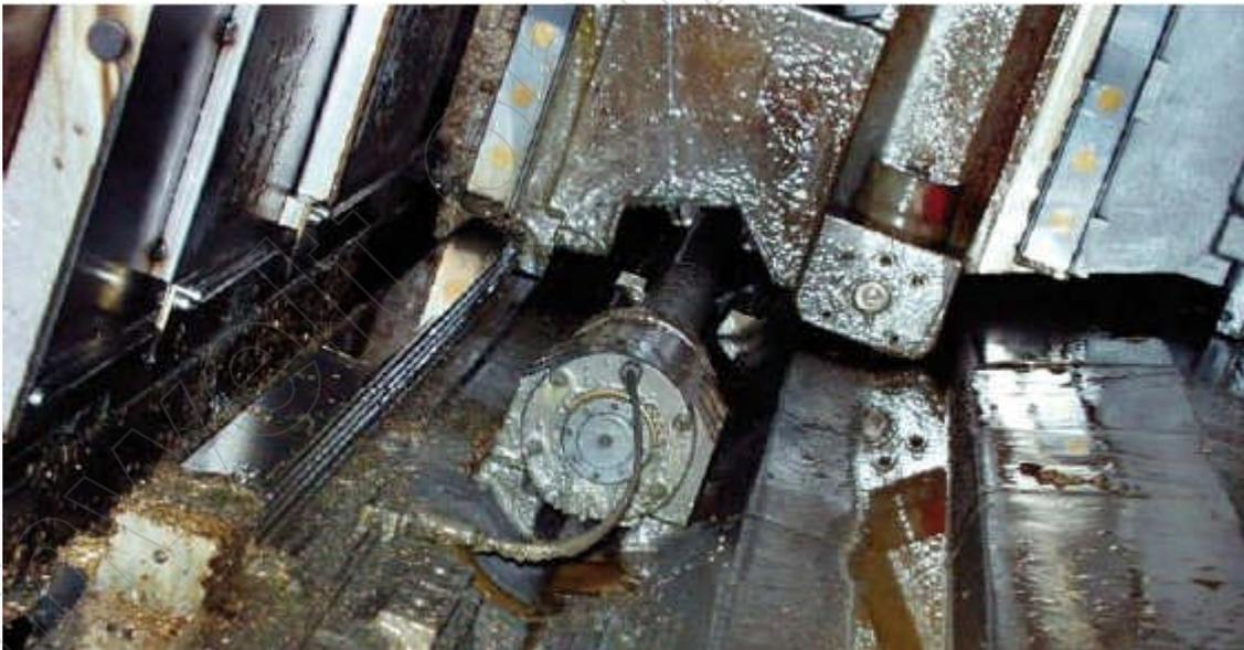
Bild 22: Werkzeugmaschine im "Ölbad"
