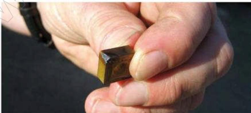
**Bild 20: Heißgelaufener Bohrer als Zündquelle**
