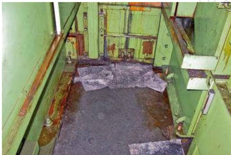
Weiterhin sind die Spänebehälter regelmäßig zu entleeren, um die Brandlast zu verringern und ggf. einer Selbstentzündung vorzubeugen. Werden die Späne aufgrund der Last unter hohem Druck mehrere Tage gelagert, kann durch eine exotherme Reaktion ein Erwärmungsprozess bis hin zur Selbstzündung eintreten.
