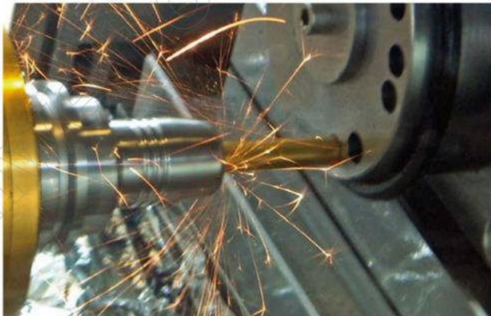
Oftmals ist die vorgenannte Entzündung des KSS-Luftgemisches im Maschineninnenraum mit einem Folgebrand verbunden. Kommt es zu Flammenaustritten aus Öffnungen und Spalten, besteht die Gefahr, dass ein Maschinenbrand auf die Umgebung übergreift.
