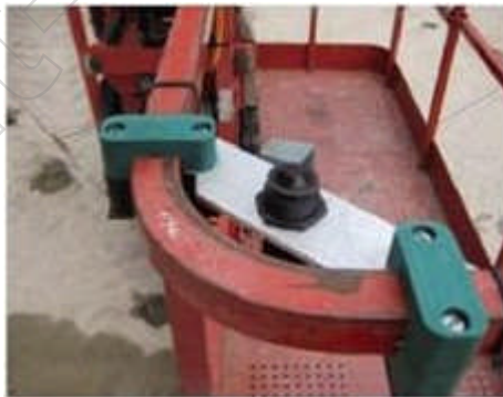
Bild 6-5: Absicherung von Bedienpult und Geländer durch Sensortechnik
