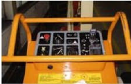
Bild 6-4: Absicherung von Bedienpult und Geländer durch eine Abschaltleiste gegen Quetschgefahren
