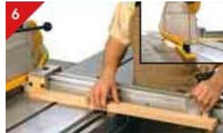
Ablängen schmaler Werkstücke mit Queranschlag
