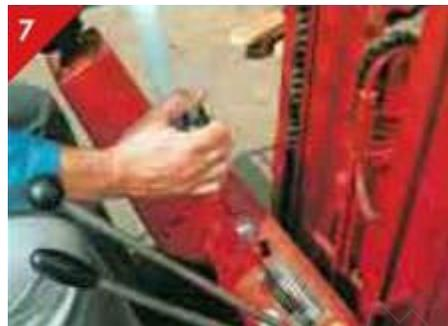
Vor Verlassen des Flurförderzeuges Feststellbremse anziehen und Gabeln absenken. Auf geneigten Flächen zusätzlich durch Unterlegkeile sichern.
