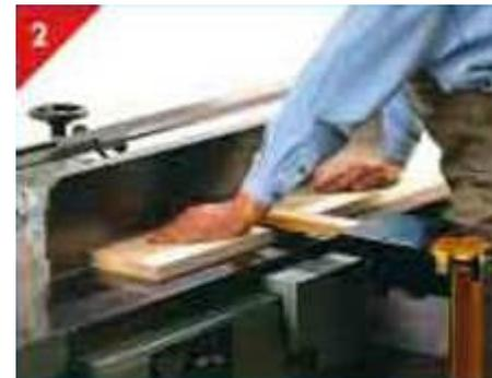
Abrichten breiter Werkstücke mit Schutzbrücke
