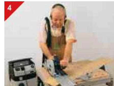
Bei Montageschnitten für sichere Werkstückauflage und präzise Werkzeugführung sorgen
