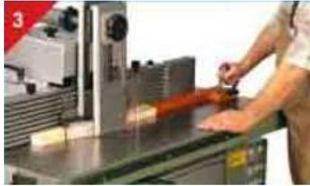
Fräsen von kleinen Werkstücken mit Druck- und Schutzvorrichtung und Schiebehholz
