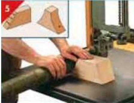
Querschneiden von Rundholz mit Keilstütze
