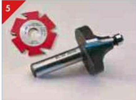
Fräswerkzeuge müssen für Handvorschub zugelassen sein (z. B. BG-TEST-Prüfzeichen)
