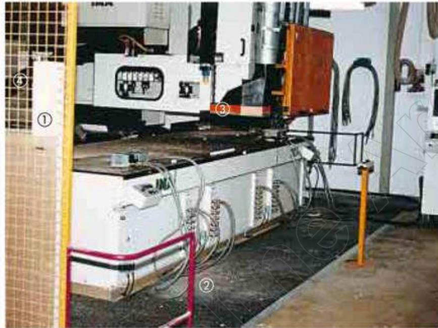
1. Umzäunung/ Kapselung mit elektrischer Verriegelung      3. Bumper
