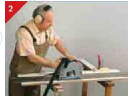
Zuschneiden von Massivholz mit Führungsschiene
