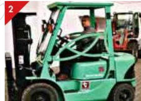
Bei jeder Fahrt Fahrerrückhalteinrichtung (z. B. Fahrersitzgurt oder Bügeltür) verwenden.
