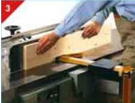
Fügen breiter Werkstücke mit Schutzbrücke
