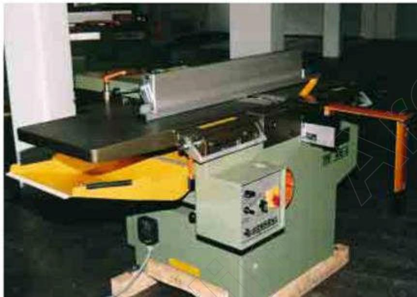
Der Zugriff zum unteren Teil der Messerwelle muss verhindert werden, z. B. durch die unten angebrachte Absaughaube. Die Messerwellenverdeckung vor und hinter dem Anschlag muss montiert und wirksam sein.
