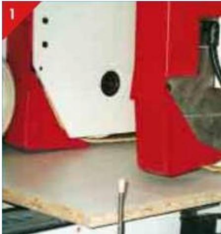
Werkstückaufnahme gesichert, z. B. durch Pendelklappe
