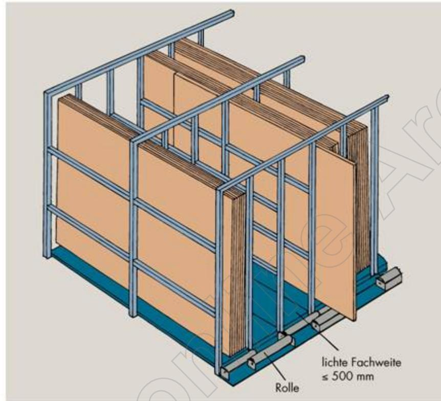
Das Einbringen und Entnehmen von Platten kann durch vorgesezte Rollen und einen glatten Bodenbelag mit geringem Gleitwiderstand wesentlich erleichtert werden.
