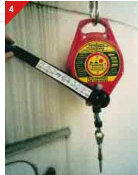
Höhensicherungsgerät mit Rettungshubeinrichtung
