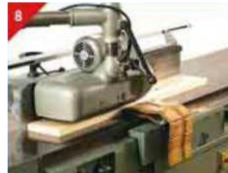
Abrichten von Werkstücken mit dem Vorschubapparat
