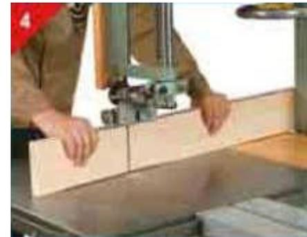
Querschneiden von hochkant stehenden Werkstücken mit Anlage am Maschinenständer
