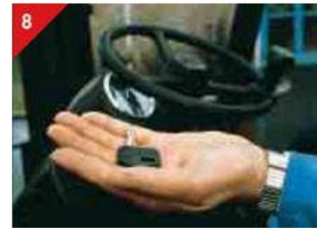
Gabelstapler erst verlassen, wenn der Antrieb stillgesetzt und der Schlüssel abgezogen ist.
