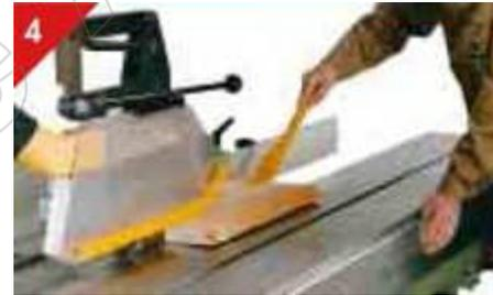
Schneiden schmaler Werkstücke mit Schiebstock
