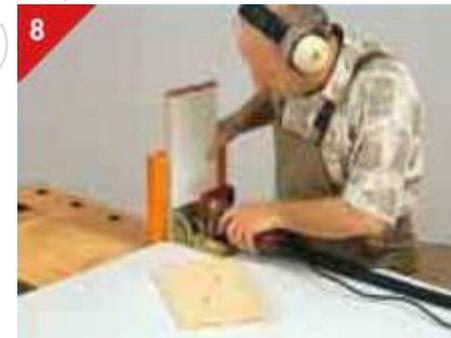
Einfürungen von Nuten mit Stützwinkel
