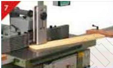
Einsetzfräsen großer Werkstücke mit Rückschlagsicherung
