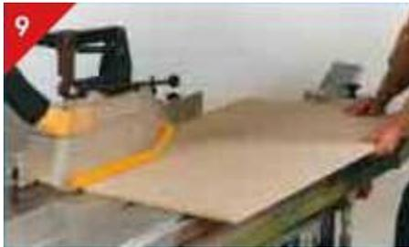
Schutzeinrichtungen und Handhaltung beim Einsetzschneiden
