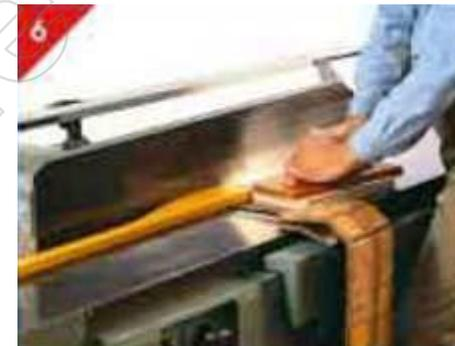
Abrichten kurzer Werkstücke mit Zuführlade
