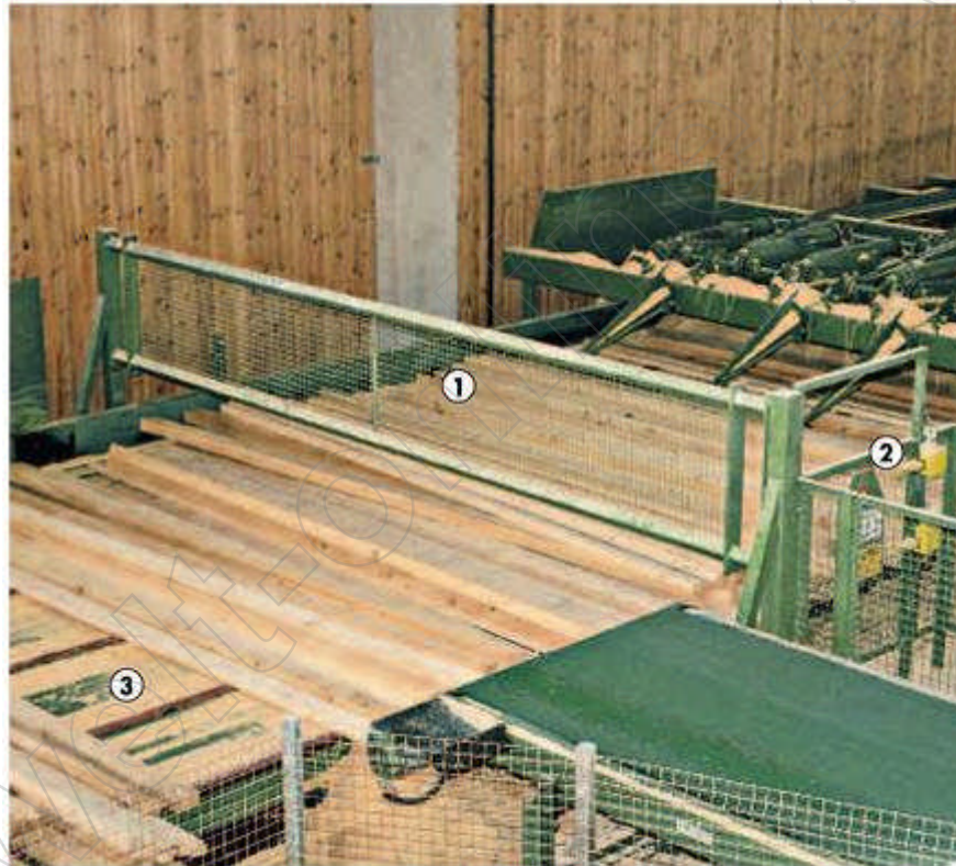
Abb. 29 Ausführungsbeispiel Stetigförderer für Seitenwarenabtransport, um den Zugang zum Gefahrenbereich der Einschnittlinie zu verhindern
