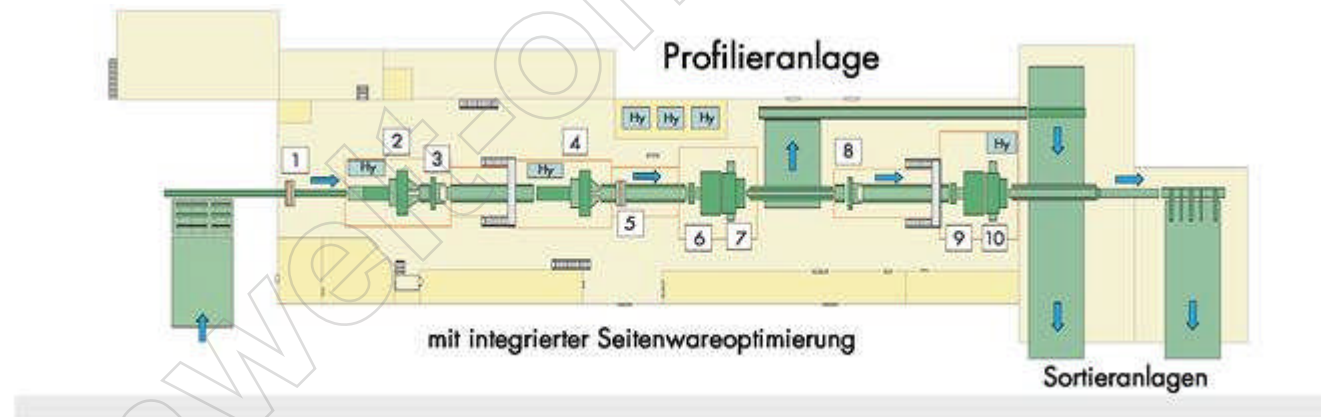
Abb. 9 Prinzipieller Einsatz von Spaner, Profilfräs- und Sägeaggregaten (Quelle Linck)
