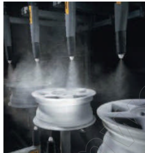
Bild 1: Automatisches (stationäres) Sprühsystem zur Beschichtung von Pkw-Aluminiumrädern für Klarlack (Wagner)
