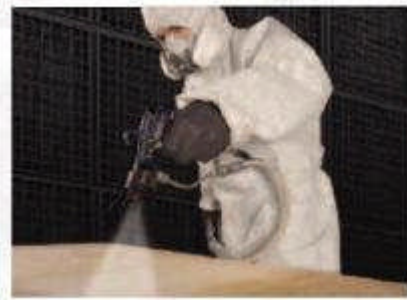
Bild 2: Manuelles Beschichten von Holzplatten mit luftzerstäubendem Handsprühsystem für wasserverdünnbaren Flüssiglack (Außenaufladung-Wagner)
