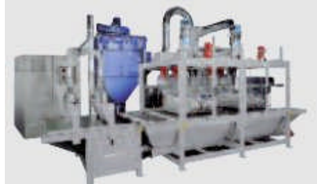
Bild 2: Automatische (stationäre) Flächenbeflockungsanlage (Maag)
