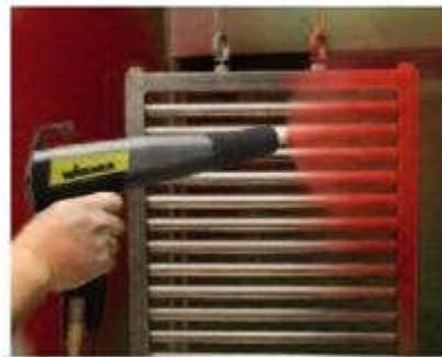
Bild 2: Pulverhandsprühsystem zur Beschichtung von Heizkörpern (Wagner)
