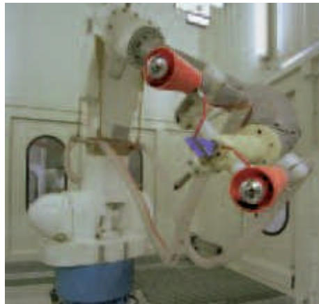
Bild 3: Robotergeführte automatische (stationäre) Beflockungsanlage mit luftzerstäubenden Sprühsystemen (Maag)
