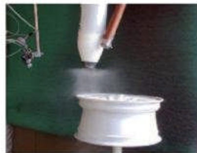
Bild 1: Automatisches (stationäres) Hochrotations-Sprühsystem zur Beschichtung von Pkw-Aluminiumrädern für Decklack (ITW)
