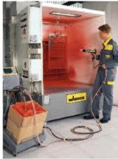
Bild 1: Pulverhandsprühanlage mit Sprühkabine (Wagner)
