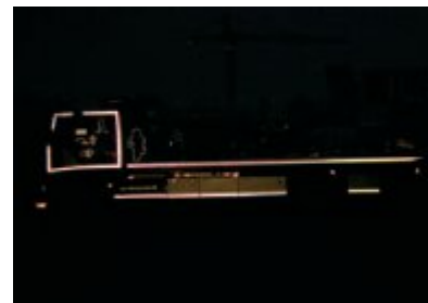
Bild 6: Beleuchtung der Konturmarkierung mit einer Taschenlampe bei Nacht
