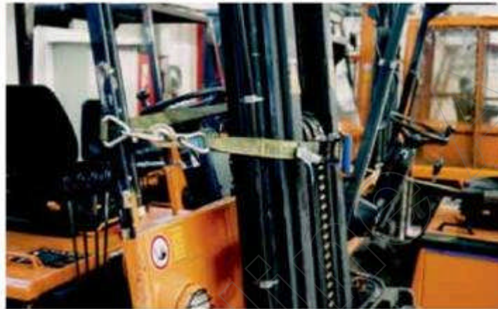
Bild 36: Festgezurrtes Hubgerüst bei Arbeiten an Neigezylindern
