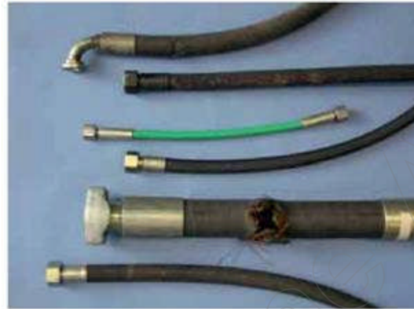
Bild 16: Beispiele ausgefallener Hydraulik-Schlauchleitungen
