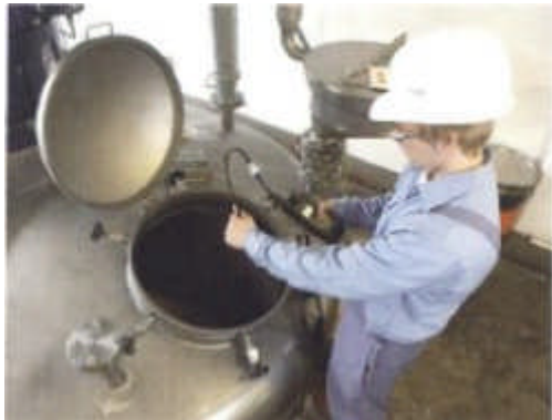
Abbildung 19: Probenahme mittels Gasmessgerät Abbildung 20: Probenahme mittels Gassammelrohr
