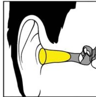
Abb. 8: Ausreichend tief im Gehörgang eingesetzte Gehörschutzstöpsel in kleinem und großem Gehörgang
