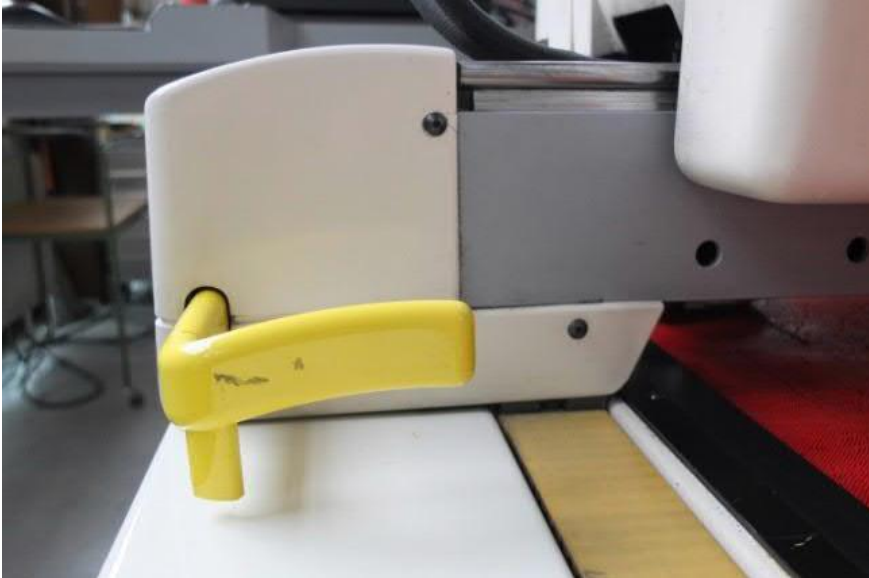
Bild 6: Schaltleisten sichern die Fahrbewegung der Schneidbrücke
