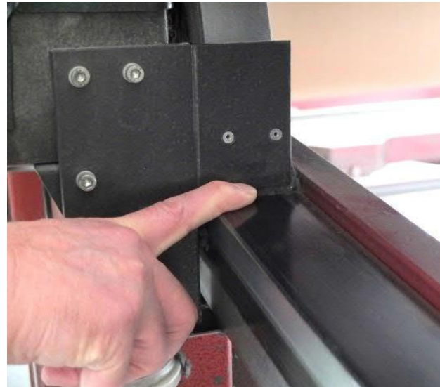
Bild 3: Absicherung der Räder durch Schienenräumer
