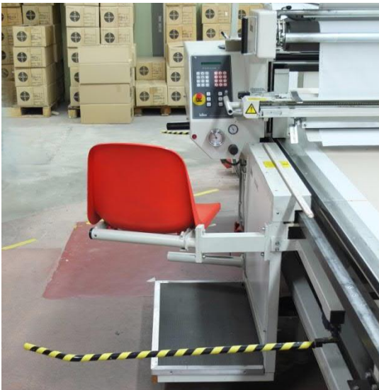
Bild 2: Ein Schaltbügel sichert die Fahrbewegung am Legewagen
