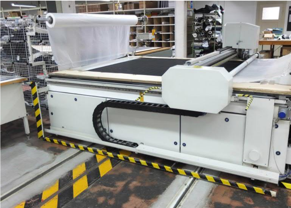
Bild 8: Schaltleisten sichern Fahrbewegungen des Transfertischs
