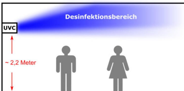
Abbildung 3: Schemazeichnung des Desinfektionskonzepts von Herstellern für einen Wandstrahler.
