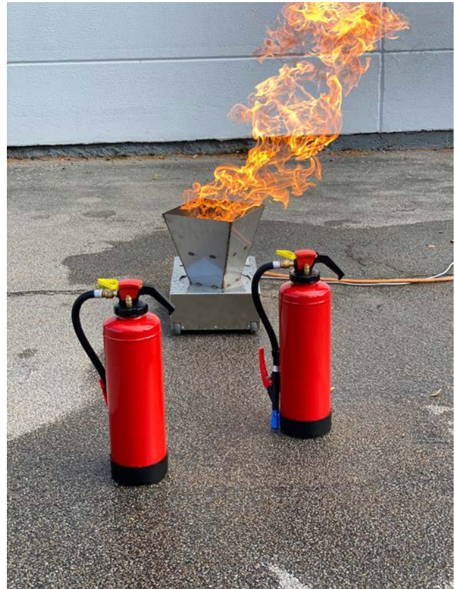
Abb. 6 Brandsimulator mit bereitgestellten Übungsfeuerlöschern
