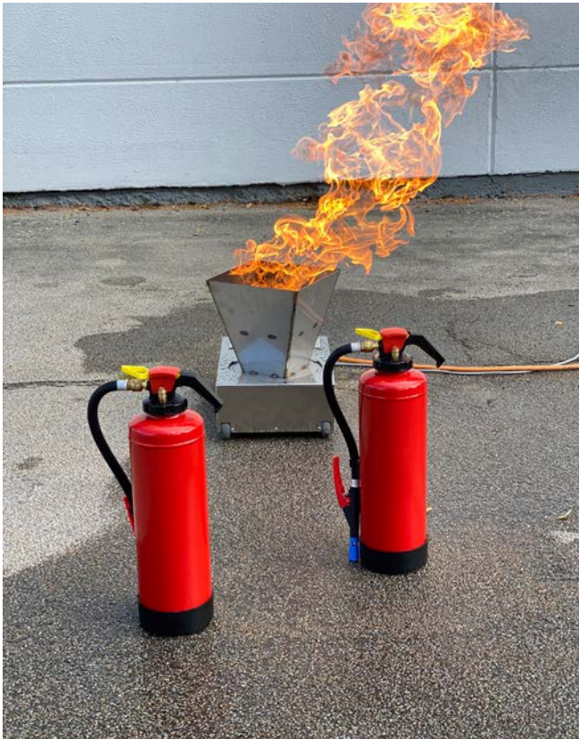
Abb. 3 Bereitgestelltes Brandsimulationsgerät mit Übungsfeuerlöschern
