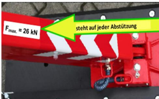
Bild 5: Abstützung mit angegebenem max. Stützdruck
