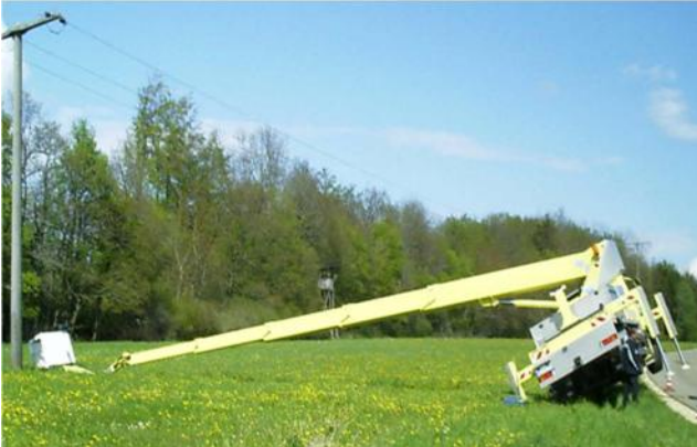
Bild 1: Umgestürzte FHAB durch zu geringe Bodentragfähigkeit
