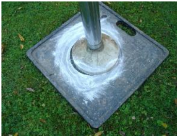
Bild 6: Mittige Auflage erzeugt gleichmäßige Lastverteilung
