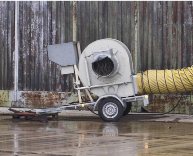
Bild 2: Ventilator, ca. 10.000m 3 /h
