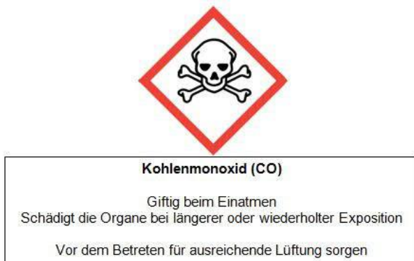
Bild 1: Kennzeichnung von Bereichen mit erhöhter CO-Konzentration
