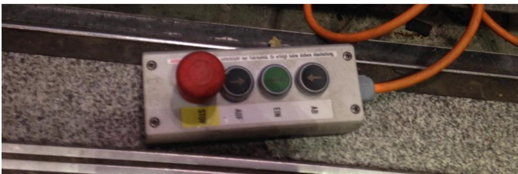
**Bild 1:** Beispiel für eine Einhandsteuerung, die mit mindestens 2 Fingern zu bedienen ist
