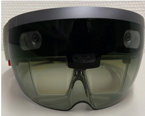
Abbildung 3: binokulare Datenbrille Microsoft HoloLens, Quelle: M. Kempf
