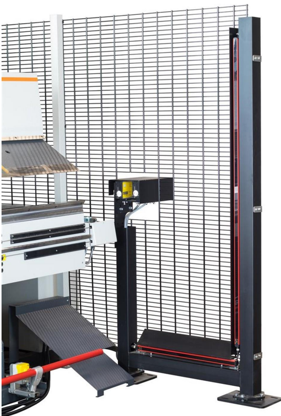
Abbildung 14 – Beispiel Langabkantmaschine als Doppelbieger mit vertikalem und horizontalem Lichtvorhang als Zutrittsschutz und Hintertretschutz sowie Schutzzaun und Laserstrahlen (vgl. Kap 3.1.4)
