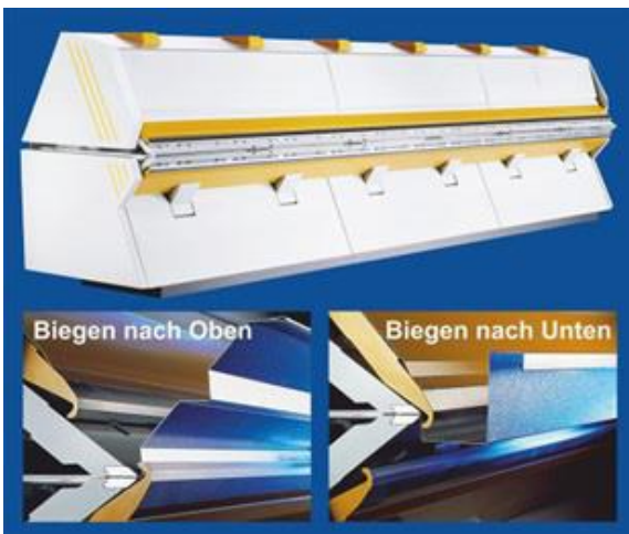
Abbildung 8 – Beispiel Langabkantmaschine mit zwei Biegewangen, d. h. Biegen nach oben sowie Biegen nach unten
