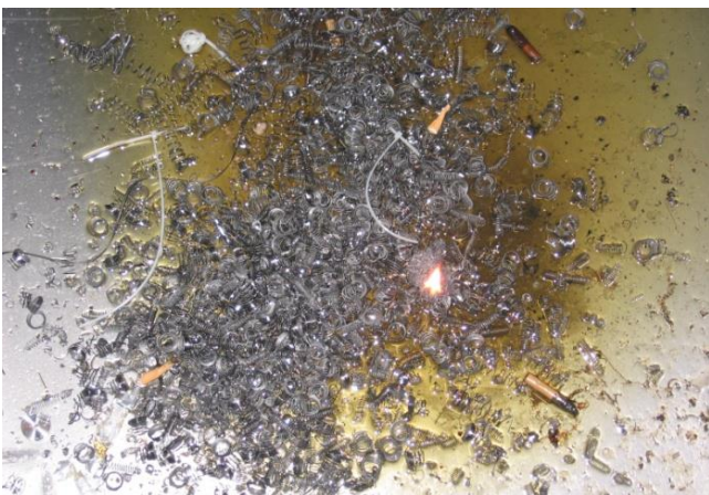
Bild 7: Zündquellen Zigarettenkippen, Brand im Spänebehälter
