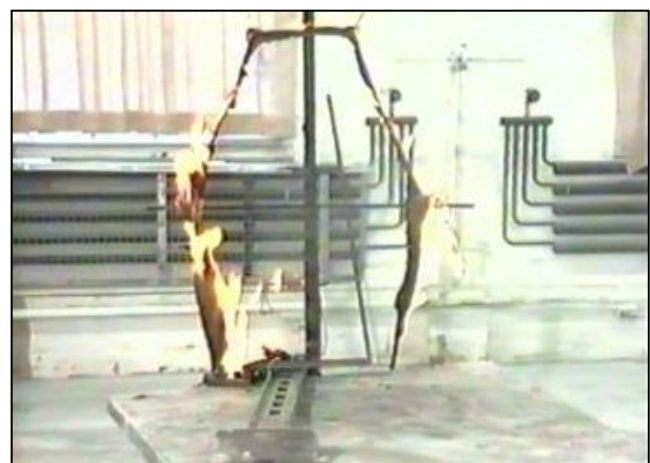
Bild 5: Segeltuchschürze aus Bild 4 nach dem Abbrand
