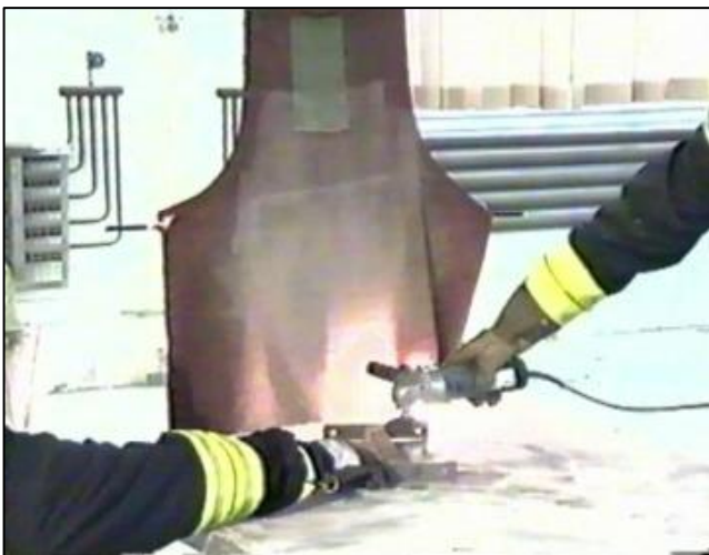
Bild 3: Nachstellung Funkenflug auf eine mit Magnesiumstaub behaftete Segeltuchschürze
