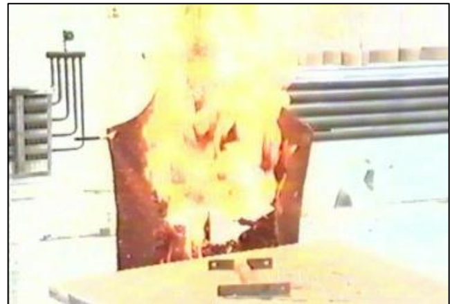
Bild 4: Sehr heftige Reaktion der Segeltuchschürze aus Bild 3
