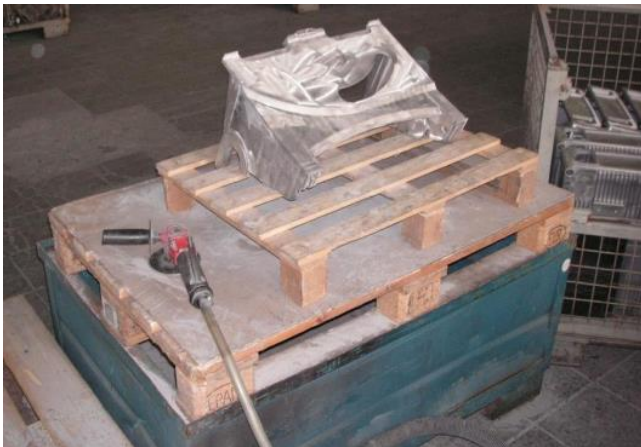
Bild 2: Ungeeigneter „improvisierter“ Schleifarbeitsplatz
