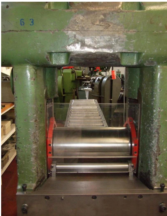
Abbildung 9 – Blechwalze mit fester Verdeckung und ebenfalls abgesicherter Vorrichtwalze
