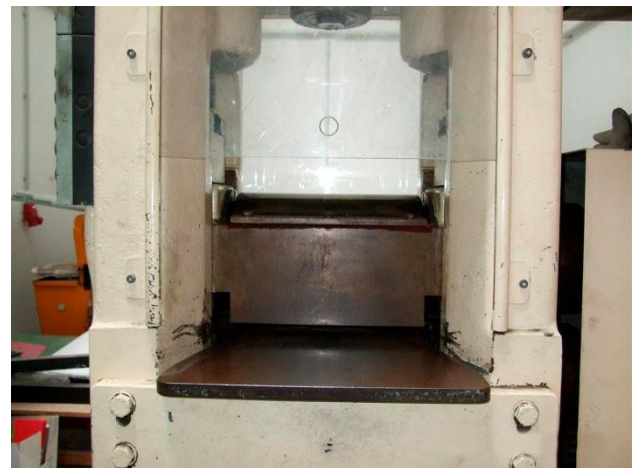
Abbildung 7 – Feste Verdeckung beim Blechwalzen
