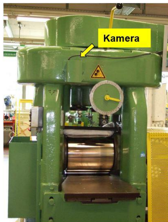
Abbildung 14 – Mit einer Kamera ausgerüstetes Walzwerk
