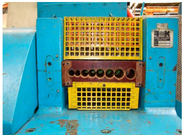
Abbildung 1 – Fest angebrachte trennende Schutzeinrichtung aus Hartholz an einer Drahtwalze
