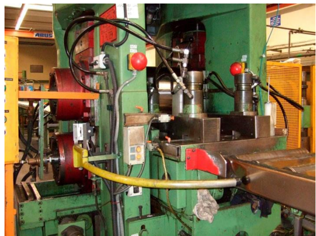
Abbildung 11 – Sicherheit durch Abstand. Die Einzugsstelle ist wegen des eingesetzten Bügels nicht erreichbar.
