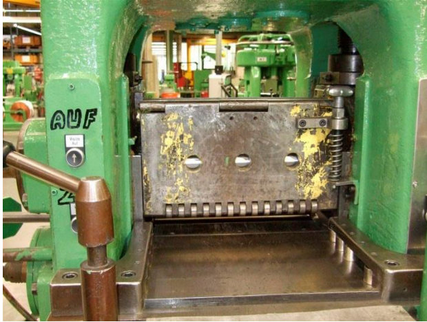
Abbildung 12 – Beweglicher Handabweiser. Er folgt der Bewegung des aufbiegenden Materials
