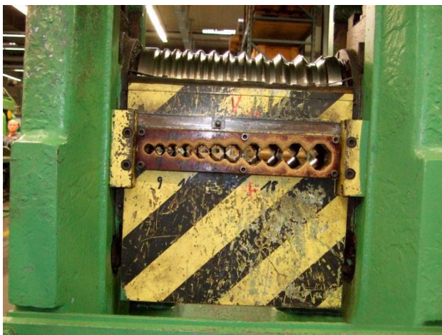
Abbildung 4 – Fest angebrachte trennende Schutzeinrichtung aus Pertinax an einer Drahtwalze
