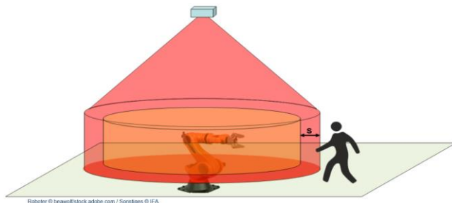
Bild 1: Eine über dem Roboter installierte BWS (blau) überwacht einen zylindrischen Schutzraum (rot) mit aufgesetztem Kegel
