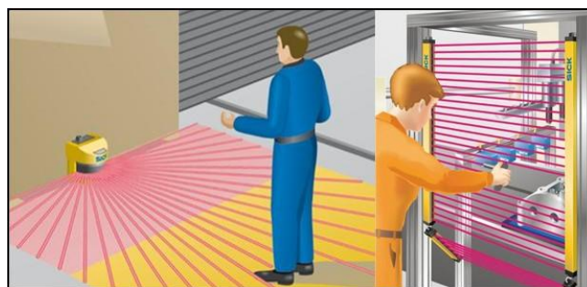
Abbildung 1 – BWS-Beispiele: Sicherheits-Laserscanner und -Lichtvorhang
