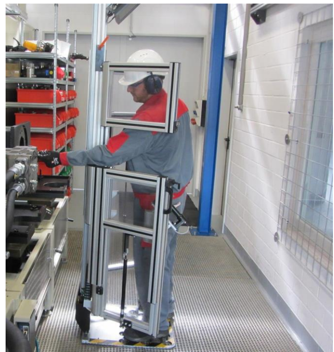
Bild 7: Manuell einstellbare Schutzeinrichtung für größtmöglichen Schutz bei Einstellarbeiten an Pumpenprüfstand in separatem Prüfraum
