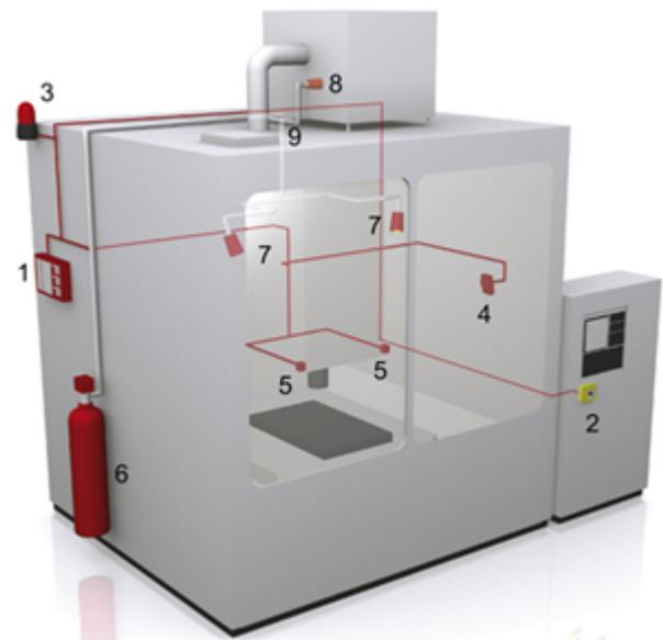
Abbildung 1 – Feuerlöschanlage in einer Werkzeugmaschine
