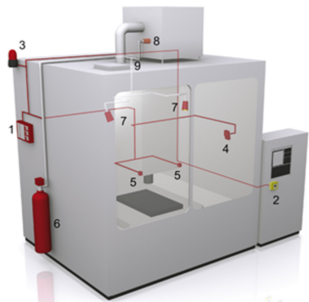
Abbildung 1 – Feuerlöschanlage in einer Werkzeugmaschine
