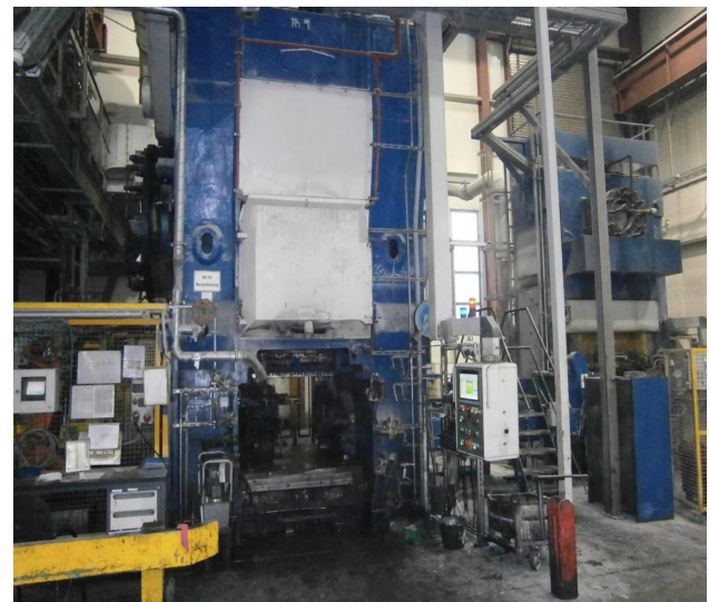
Abbildung 1 – Vorderansicht einer Schmiedepresse
