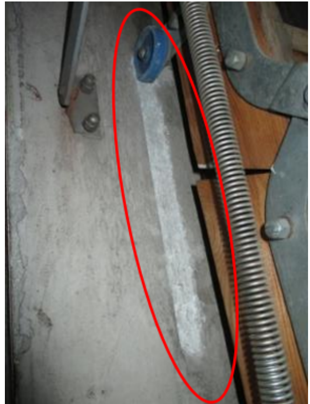
Abbildung 4 – Faserfreisetzung infolge Abrieb durch die Führungsrolle auf dem Lukendeckel
