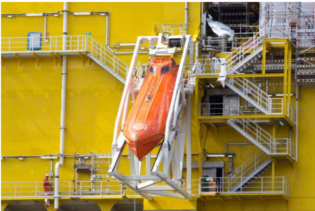
Bild 2: Freifallrettungsboot mit Aus- und Einsetzvorrichtung
