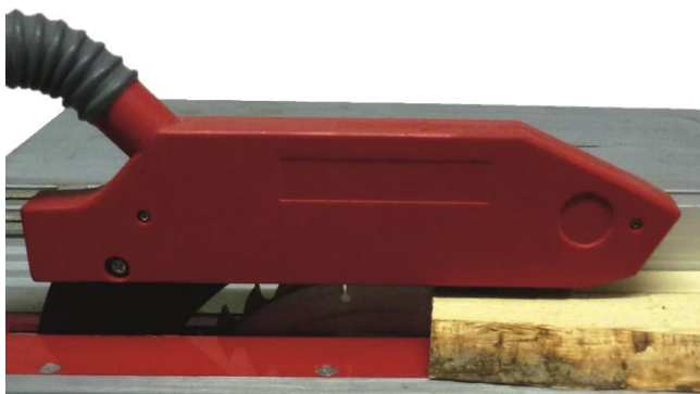
Bild 9: Schutzhaube am Spaltkeil befestigt
