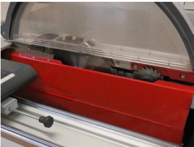
Bild 15: Sägeblattzugang unter dem Tisch
