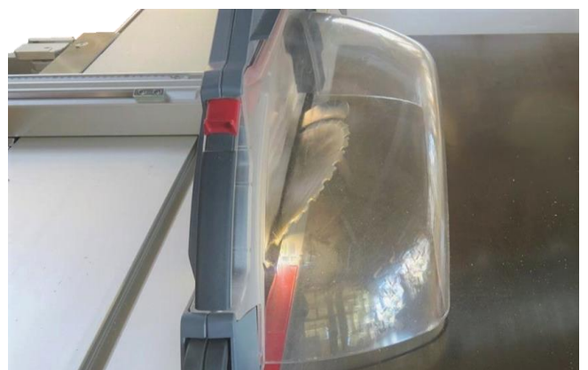
Bild 11: Breite Schutzhaube bei schräggestelltem Sägeblatt
