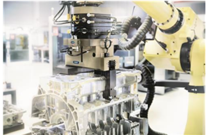
Bild 8: Formschlüssiger pneumatischer Greifer am Roboter
