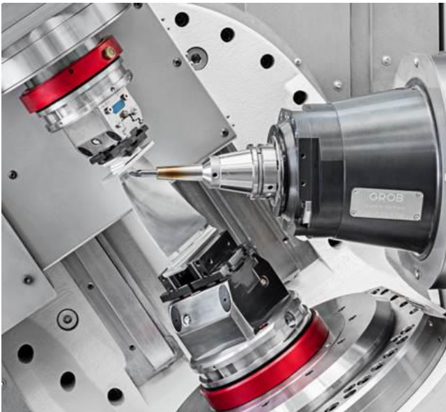
Bild 3: Zwei pneumatische Spannstöcke in CNC-Universal-Bearbeitungszentrum
