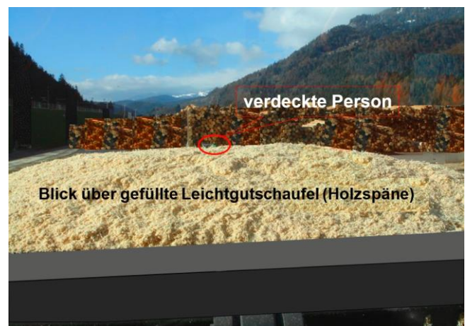
Bild 12: Blick über gefüllte Leichtgutschaufel: Person in 35 m Abstand fast vollständig verdeckt
