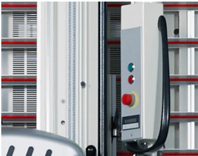
Bild 3: Beispiel für Farbkennzeichnung von Befehlseinrichtungen
