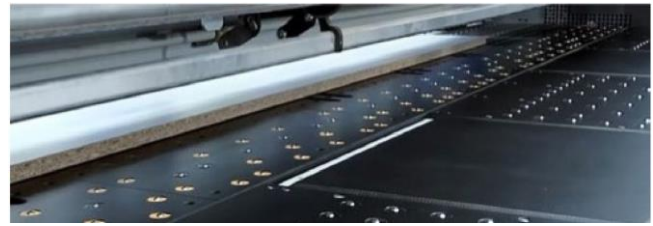
Bild 4: Beispiel einer Druckbalkensicherung durch eine Schaltleiste
