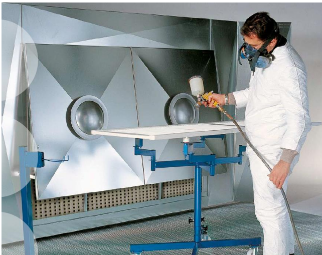
Bild 1: Manuelles Spritzlackieren an einer Absaugwand mit Trockenabscheidung
