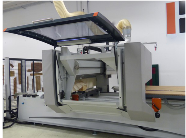
Bild 5: Beispiel CNC-Bearbeitungszentrum in Teilkapselung – Schutzkonzept unter Einbeziehung von Bumpern
