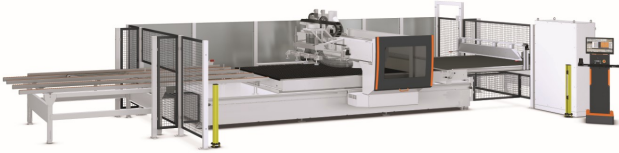
Bild 6: Beispiel eines CNC-Bearbeitungszentrums in Teilkapselung – Schutzkonzept mit allseitiger Lichtschrankenabsicherung
