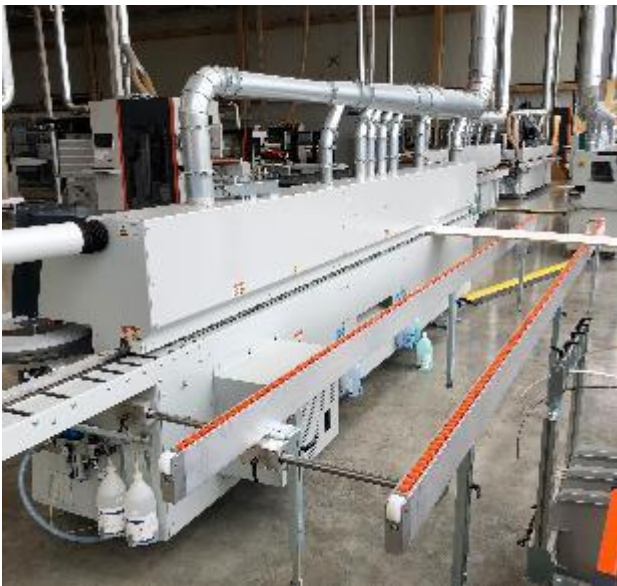
Abbildung 7 – Beispiel einer distanzierenden Schutzeinrichtung mit integrierter Werkstückauflage
