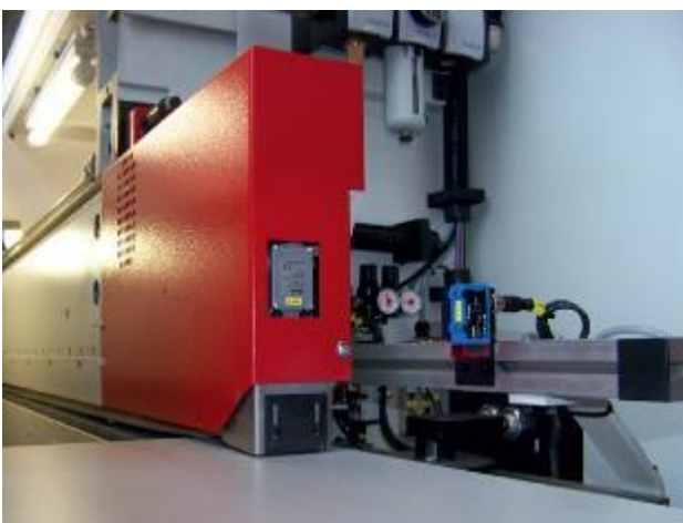
Abbildung 8 – Beispiel für eine druckempfindliche Sicherheitsschalteneinrichtung
