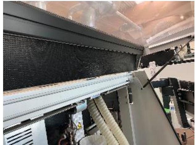
Abbildung 15 – Beispiel schalldämmender und schalldämpfender Schutzeinrichtung
