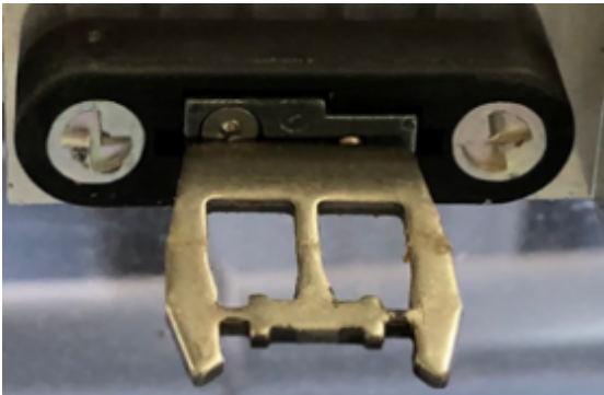
Abbildung 5 – Beispiel für die Sicherung des Betätigers an einer segmentierten Schutzeinrichtung
