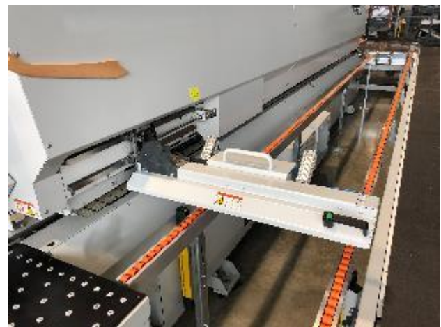
Abbildung 12 – Beispiel einer Zuführhilfe für Schmal- bzw. Kurzteile
