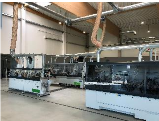
Abbildung 1 – Bauformen einseitiger Kantenanleimmaschinen
