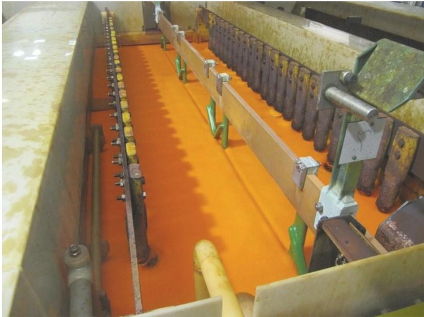
Abbildung 10 – Verchromungsprozessbehälter mit Netzmittel auf dem Elektrolyten.
